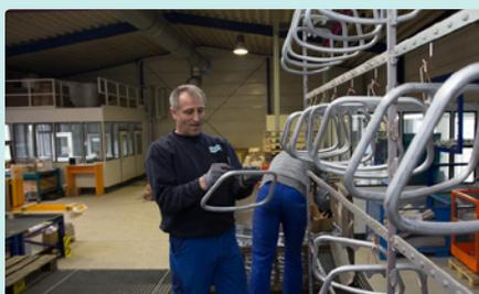
Die Werkstücke durchlaufen diverse Stationen. Los geht es mit der Reinigung des Materials und dem Aufhängen.
