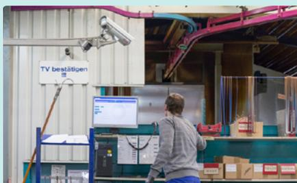
Qualitätskontrolle: Eine hochauflösende Videokamera dokumentiert die Arbeitsergebnisse. Die Bilder werden in der Software ebenfalls dem jeweiligen Auftrag zugeordnet.
