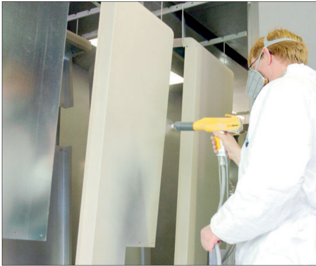
Die neue Pistole wiegt 520 g und ist u.a. mit einer Fernbedienung für die Programmumschaltung auf der Steuerung ausgestattet. Quelle: Redaktion
