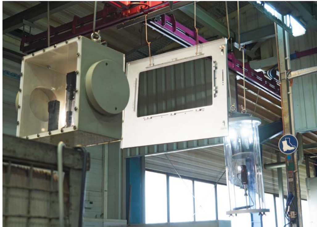
Ein typischer Aufhängenaufbau bei Realmessungen. Das 360°-System fokussiert die Performance der Kabine, das Einblick-Kamerasystem ist auf ein Bauteil gerichtet, um die ordnungsgemäße Vorbehandlung von Werkstücken zu überprüfen.
