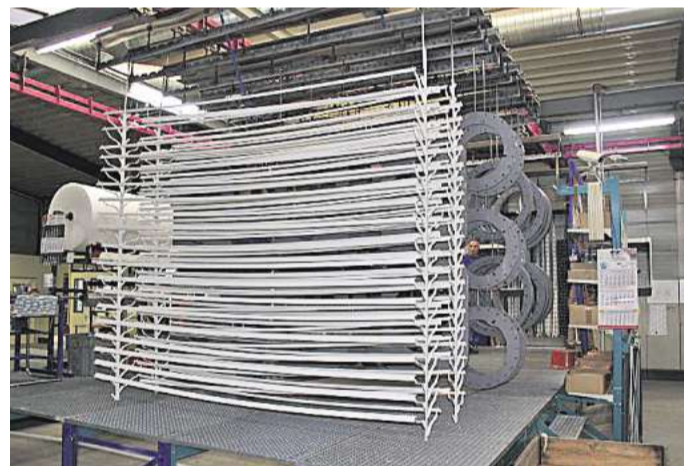
Durch ein automatisches Transportsystem wird das zu beschichtende Material zu den einzelnen Bearbeitungsschritten gebracht.
